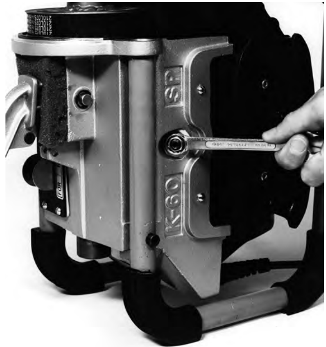
Figure 13 – Desserrez l'écrou de blocage
