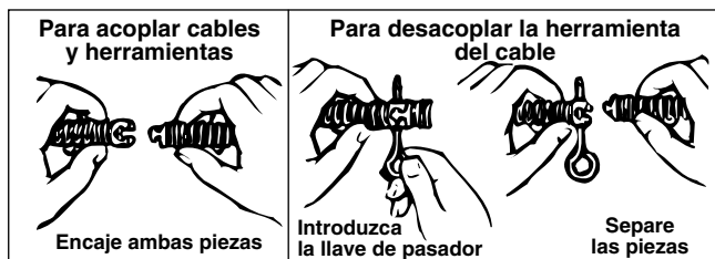
Figura 6 – Modo de acoplar y desacoplar herramientas
