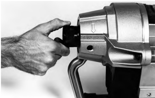
Figure 10 – Réglage des mâchoires
